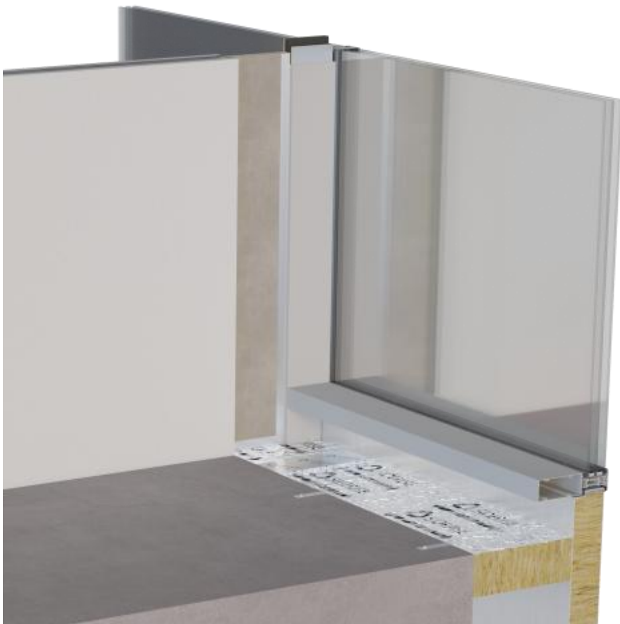
Figur 16 FIP HP akustisk panel støder op til en stolpe, efterpåført dekorativ dækplade påsat.
